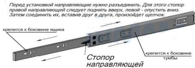
Рис.4 Схема установки шариковых направляющих
