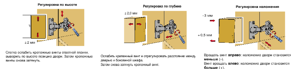
Рис.2 Схема установки петель
