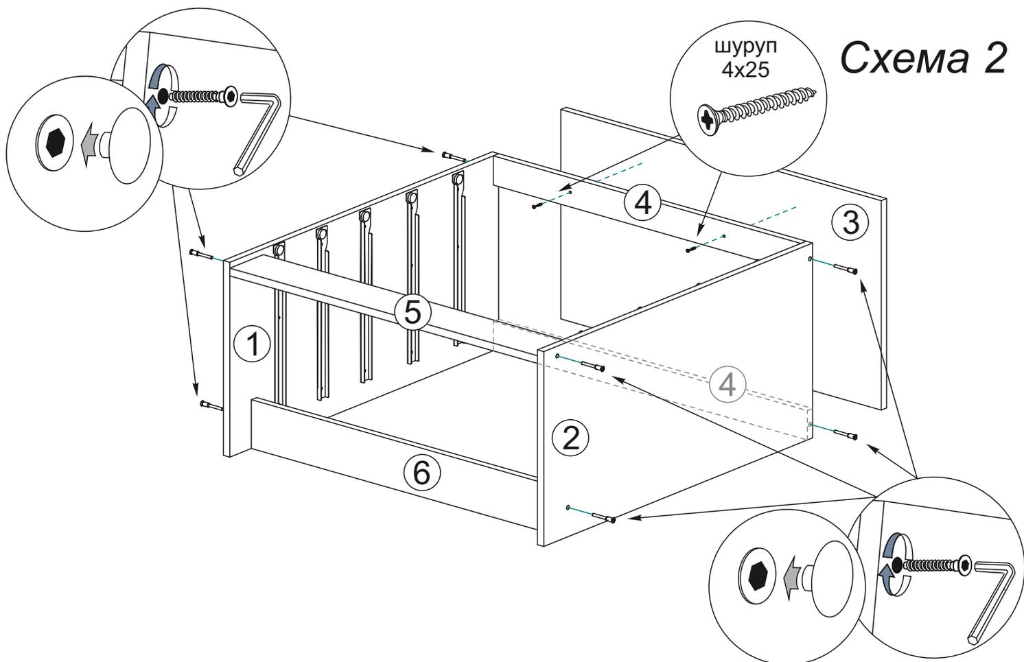
4. Чтобы установить задние стенки (детали №11), необходимо собранную конструкцию перевернуть лицевой стороной вниз. Замерить, с помощью рулетки, и уровнять диагонали ( $a=b$ ). Наложить задние стенки, проложив между ними соединительный брус №13. Аккуратно, не нарушая диагоналей, прибить ЛДВП гвоздями, шагом 130-150 мм., как показано на схеме 3
